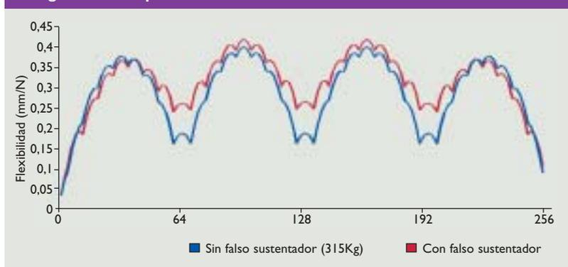
de empuje ya que la extrapolación de resultados es inviable. Normalmente el valor que se emplea para comparar distintas catenarias es de 100 N. Este parámetro pretende dar una idea de la bondad del diseño ante el paso del pantógrafo, sin embargo, debido a que no es constante en todo el vano no resulta suficiente y se hace necesario definir el llamado coeficiente de variación que da una idea de la regularidad del parámetro de elasticidad a lo largo del vano. Conviene recordar que la
